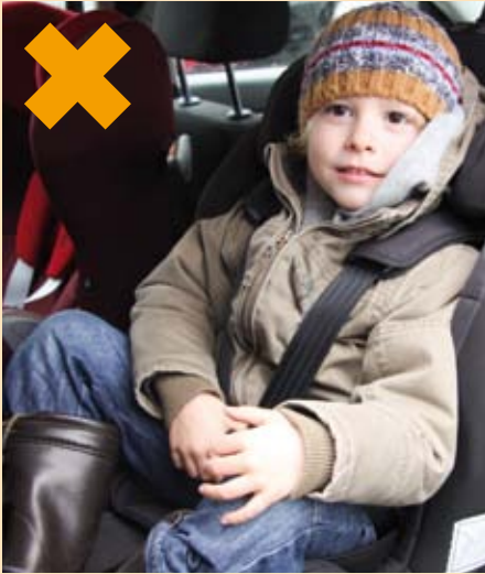
Gefährlicher Gurtverlauf: Gleiche Gurtlänge mit / ohne dick gefütterte Winterjacke
